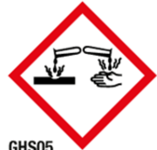
GHS05 Sustancias corrosivas (CR)
